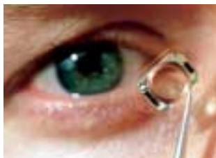
Intraokularlinse: telemetrisches Druckmesssystem, integriert in eine Intraokularlinse für die Glaukomdiagnose
